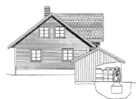
FD 5 Std. Nedgravd mottakstank under garasje/anneks
