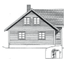
FD 5 MG, Mottakstank på gulv i kjeller
